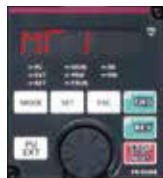
「Maintenance1輸出」警報
