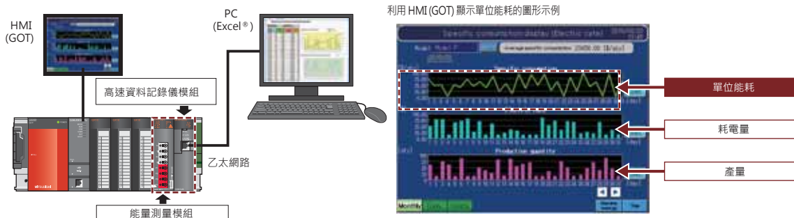
利用HMI (GOT) 顯示單位能耗的圖形示例
