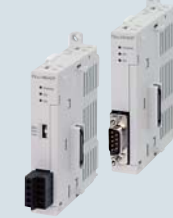
FX3U-485ADP-MB RS-485通信介面 (支援Modbus)
